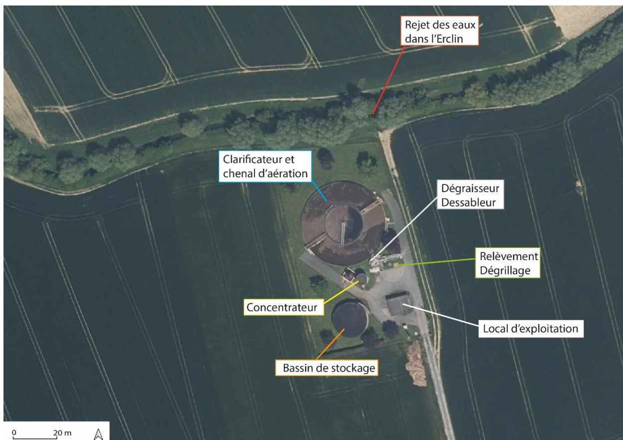
Figure 1 : Schéma de la station d'épuration existante
