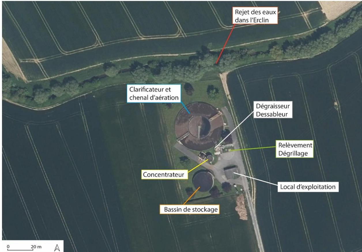
Figure 2 : Schéma de la station d'épuration existante
